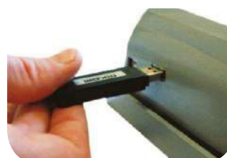
Descarga de los datos registrados a un PC via SW o directamente a un pen drive USB (opcional)
