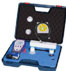
Maleta de transporte completa con accesorios, apta para ser utilizada como un laboratorio portátil
